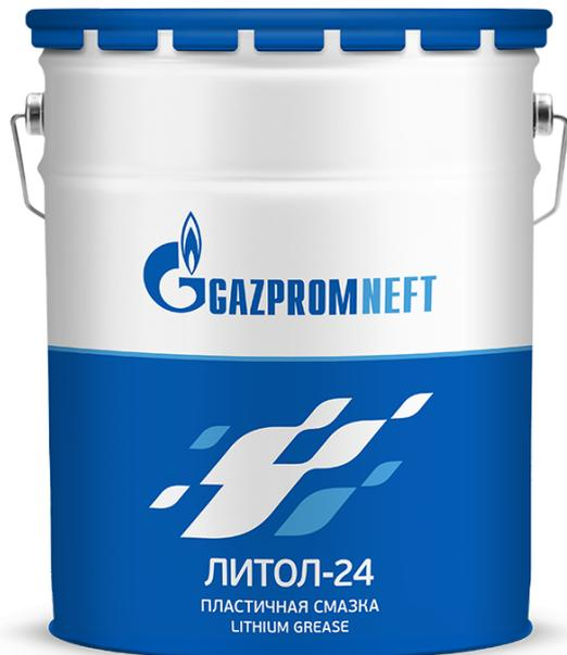
Литол-24 – антифрикционная многоцелевая водостойкая смазка на основе минерального масла, литиевого мыла и высокоэффективного пакета присадок. Применяется в подшипниках качения и скольжения всех типов, шарнирах, зубчатых и других передачах; на поверхностях трения колесных и гусеничных транспортных средств; в промышленных механизмах, электрических машинах и т.п. Работоспособна при температуре от -40 до +120 °С, кратковременно сохраняет работоспособность при температуре до +130 °С.
